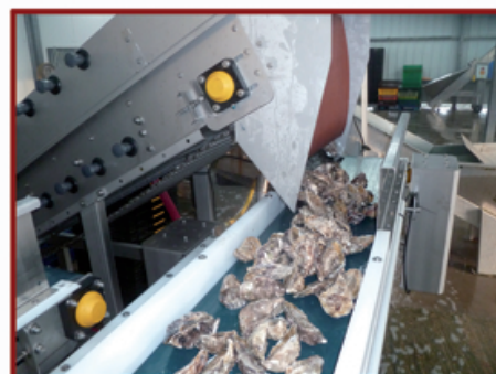
chute amortie en sortie
